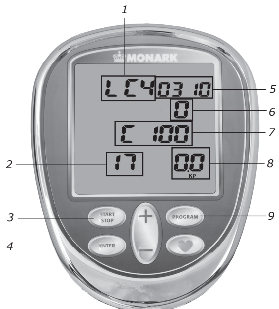
Fig: Display 'Kalibreringsläge' 1) Cykelmodell 2) Aktuellt potentiometervärde 3) START STOP 4) ENTER 5) Programversion 6) Antal timmar i användning 7) Cykelkonstant (1.00) 8) Kalibreringspunkt 9) PROGRAM
